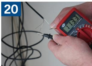
**PRUEBA #3:** pruebe la resistencia total de los cables calefactores. Cualquier cable defectuoso debe ser reemplazado.
