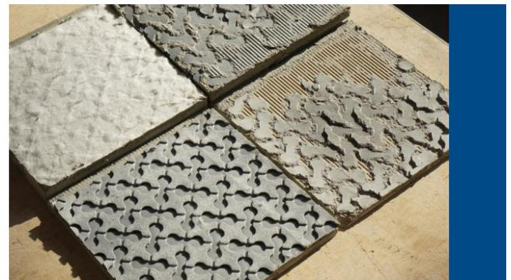
El residuo significativo de mortero en ambos la loseta y la membrana después de forzar la separación demuestra la excelente resistencia de adhesión.
